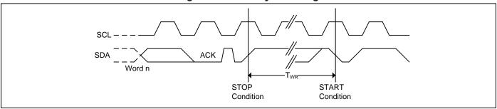
Figure 5.8. Bus Timeout Waveform
